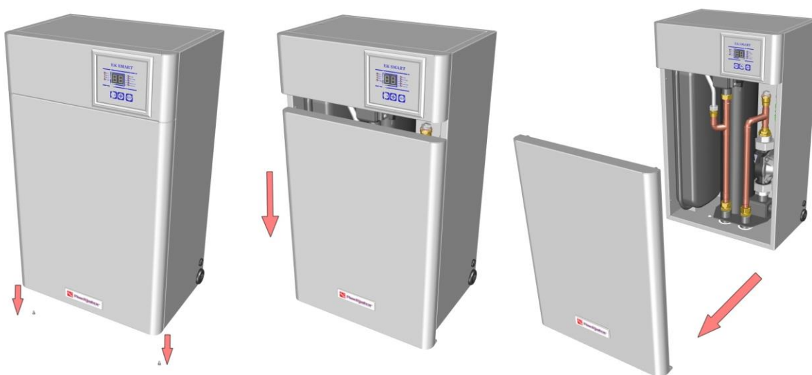
Slika 4. Otvaranje kotla (demontaža prednjeg poklopca kotla)
